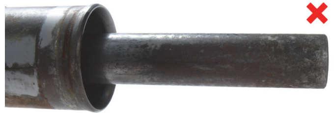
Fig. 3: Listwa zębata przekładni kierowniczej ze śladami korozji
