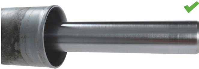
Fig. 2: Listwa zębata przekładni kierowniczej be śladów korozji
