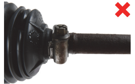
Fig. 3: Listwa zębata przekładni kierowniczej ze śladami korozji
