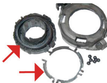
Fig. 4: Uszkodzenia mechaniczne i przegrzanie wyprzęgnika
