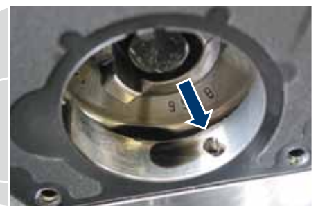
Przykład: w Oplu Vectrze olej smarowy dostarczany jest przez otwory w kołnierzu
