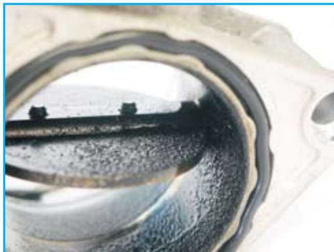
Przepustnica zanieczyszczona olejem
